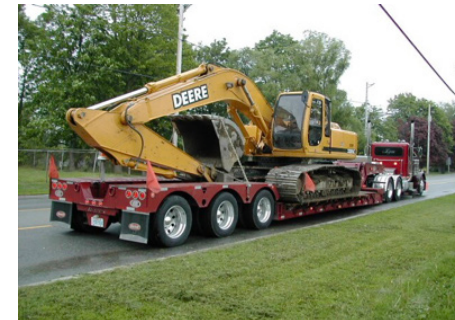
מחפר רתום בשיטת ריתום ישיר בעזרת שרשראות ריתום וחסום על ידי החלק המוגבה של המרכב (גוזניק)
