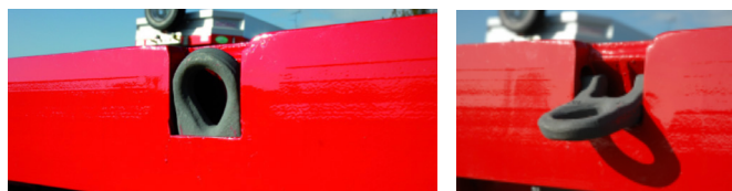
טבעות עיגון שקועות מיועדות לריתום כל סוגי התקני הריתום בעזרת אבזרי קצה שונים. התקנת טבעות עיגון קבועות מתבצעת בעיקר על דופן ההעמסה.
